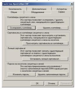
Далее следует нажать кнопку [Удалить контейнер]. В окне Удаление контейнера секретного ключа следует нажать [Обзор]:
