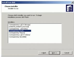
Программа находит имеющиеся считыватели в соответствии с заданными установками (число одновременно работающих считывателей определяется настройками утилиты SetupDrv.exe, значение по умолчанию - 3):
