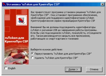
Следует выбрать нужную операцию, нажать [Далее>]. В случае, когда выбрана переустановка, после сравнения версий устанавливаемого и уже установленного в системе программного обеспечения будет произведено обновление. В случае удаления следует подтвердить свои намерения, нажав кнопку [Да].
